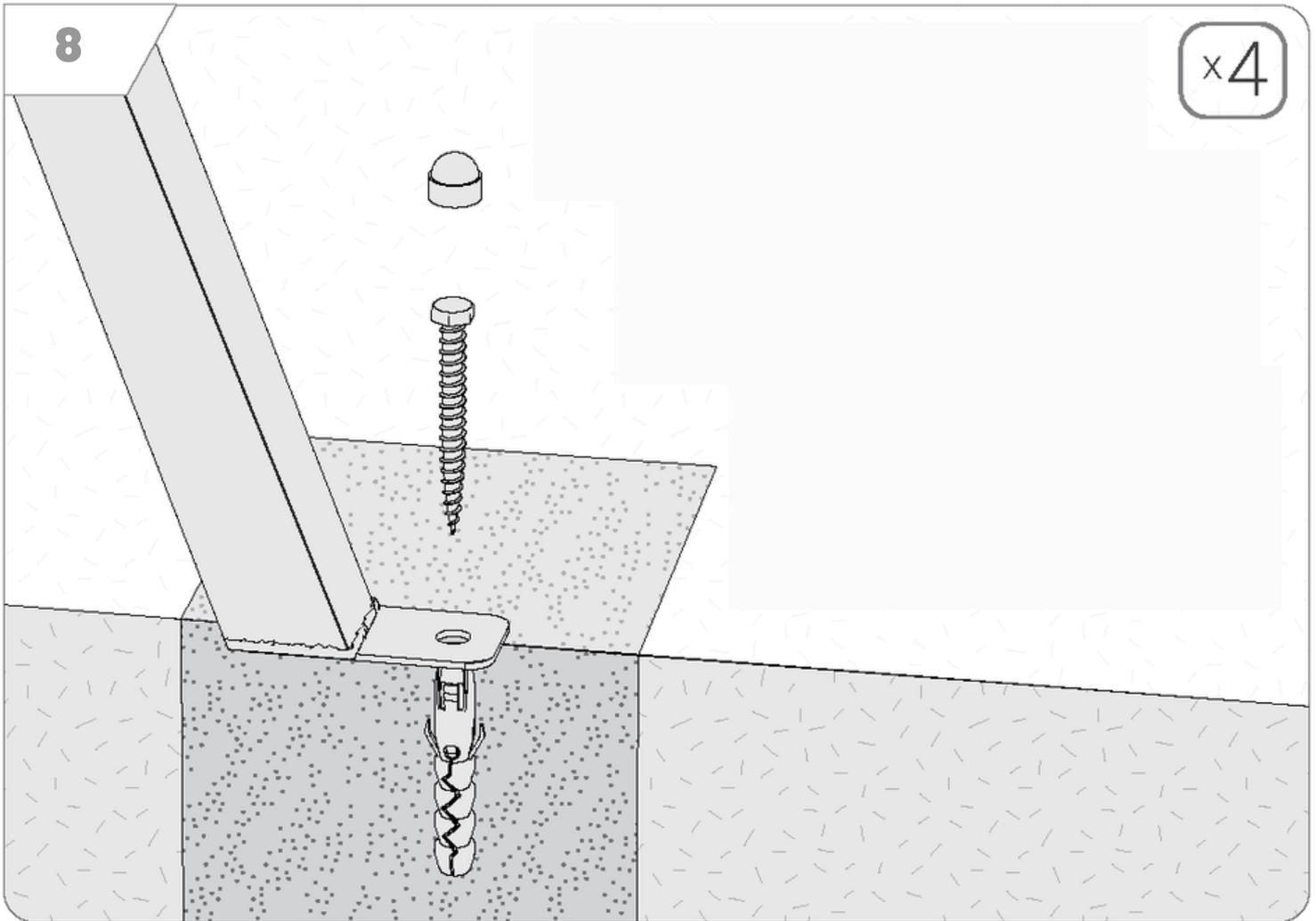
**Das Gestell erfordert eine stabile Befestigung am Boden. Du kannst Schrauben mit Dübel, Anker oder Heringe mit einer mind. Länge von 65 cm verwenden. Schon gewusst? Passende Anker bekommst du bei uns im Shop!**
