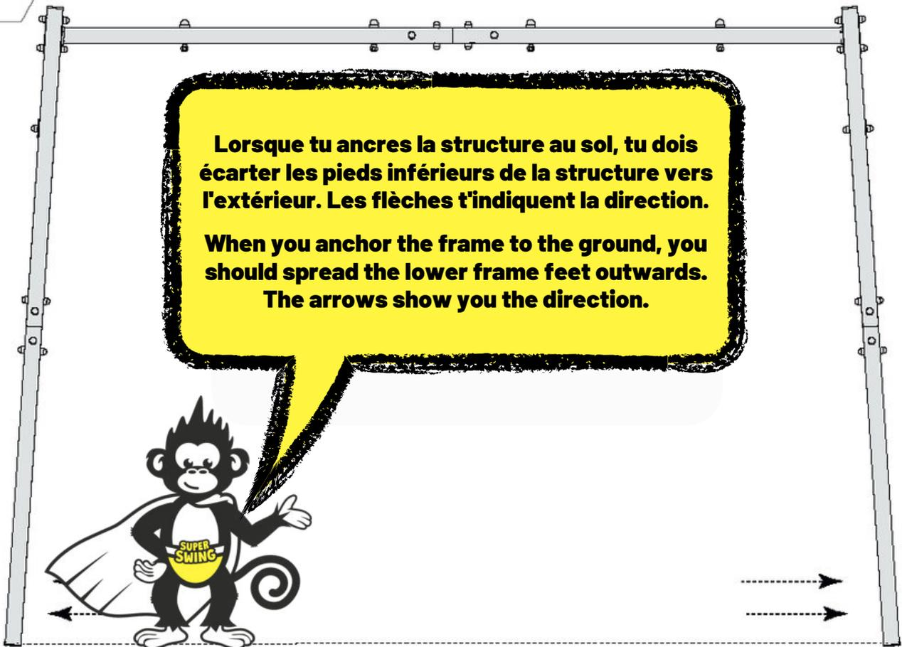
**Lorsque tu ancras la structure au sol, tu dois écarter les pieds inférieurs de la structure vers l'extérieur. Les flèches t'indiquent la direction.**
