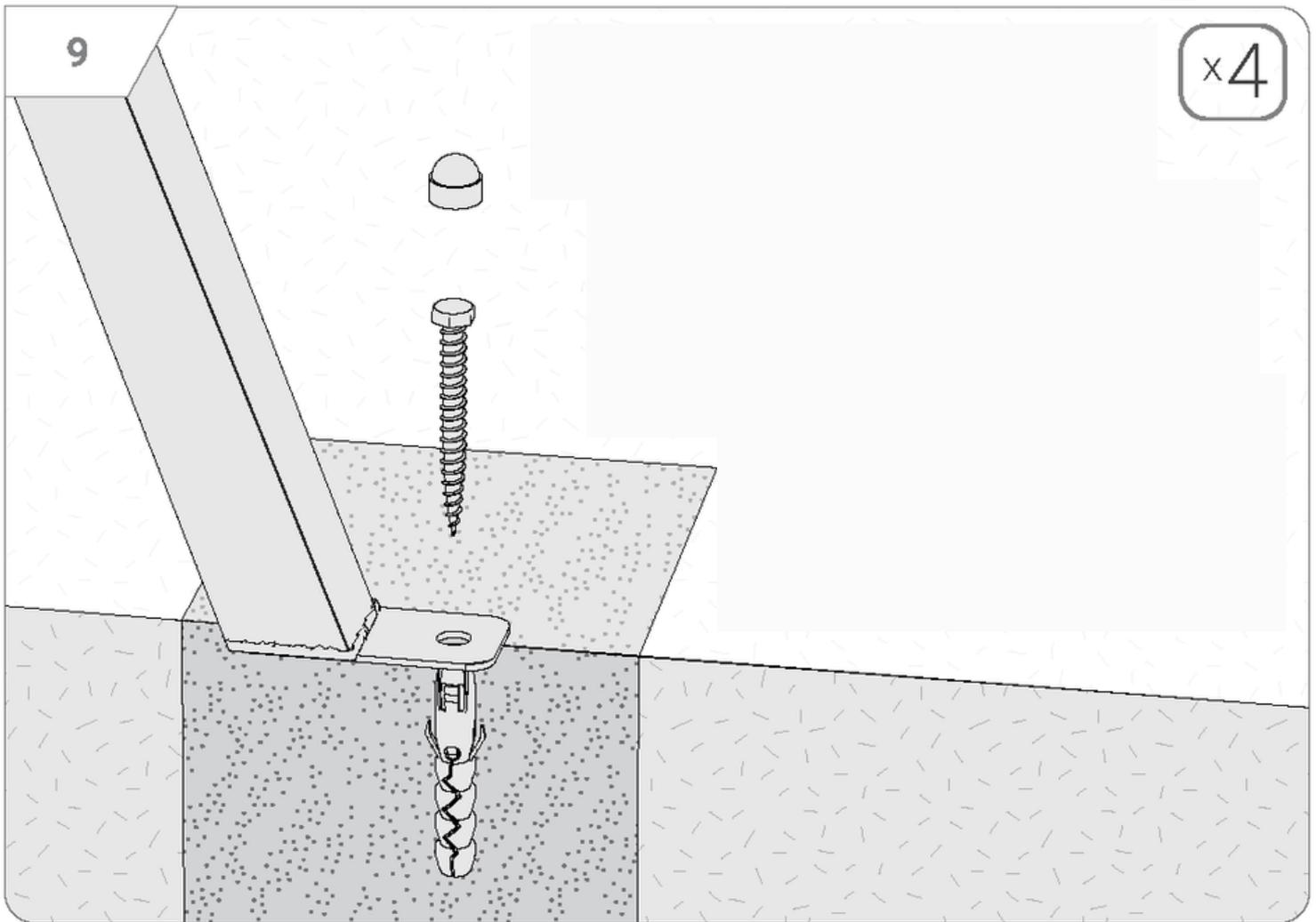
**Il telaio richiede un fissaggio stabile al pavimento. È possibile utilizzare viti con tasselli, ancore o tasselli con una lunghezza minima di 60 cm. Lo sapevate già? Nel nostro negozio troverete i tasselli adatti.**
