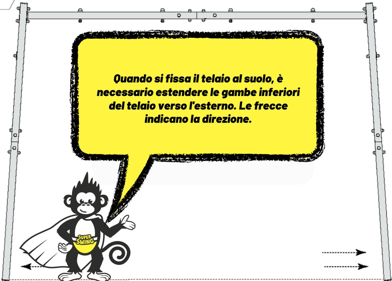
**Quando si fissa il telaio al suolo, è necessario estendere le gambe inferiori del telaio verso l'esterno. Le frecce indicano la direzione.**
